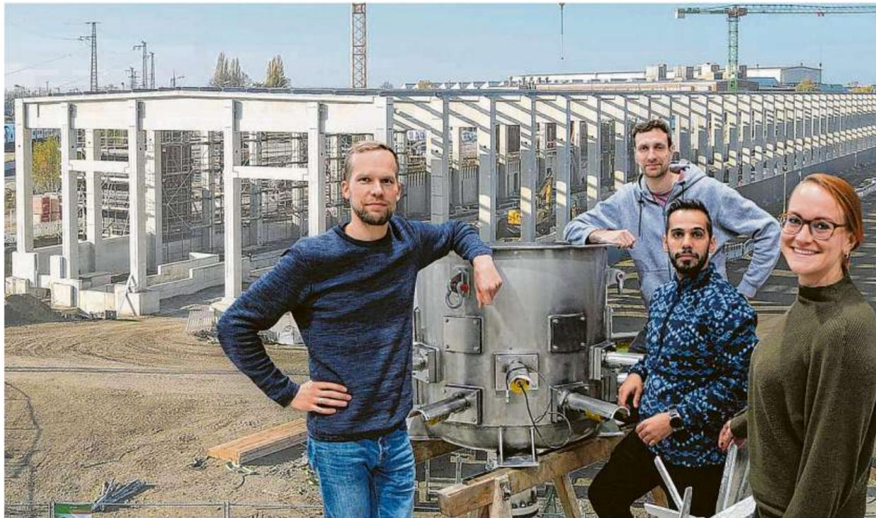
Entwicklerteam: Sonocrete-Gründer Ricardo Remus (l.) und ein Teil seiner Mannschaft. Herzstück der Ultraschalltechnik ist der Reaktor (Foto). In ihm wird ein kleiner Teil des zur Beton-Herstellung nötigen Zement-Wasser-Gemisches beschallt.
